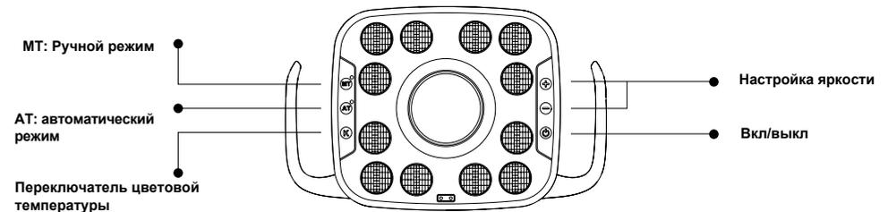
1. Касанием кнопок MT/AT можно переключаться между MT (ручным) и AT (автоматическим) режимами (обозначены индикатором).
